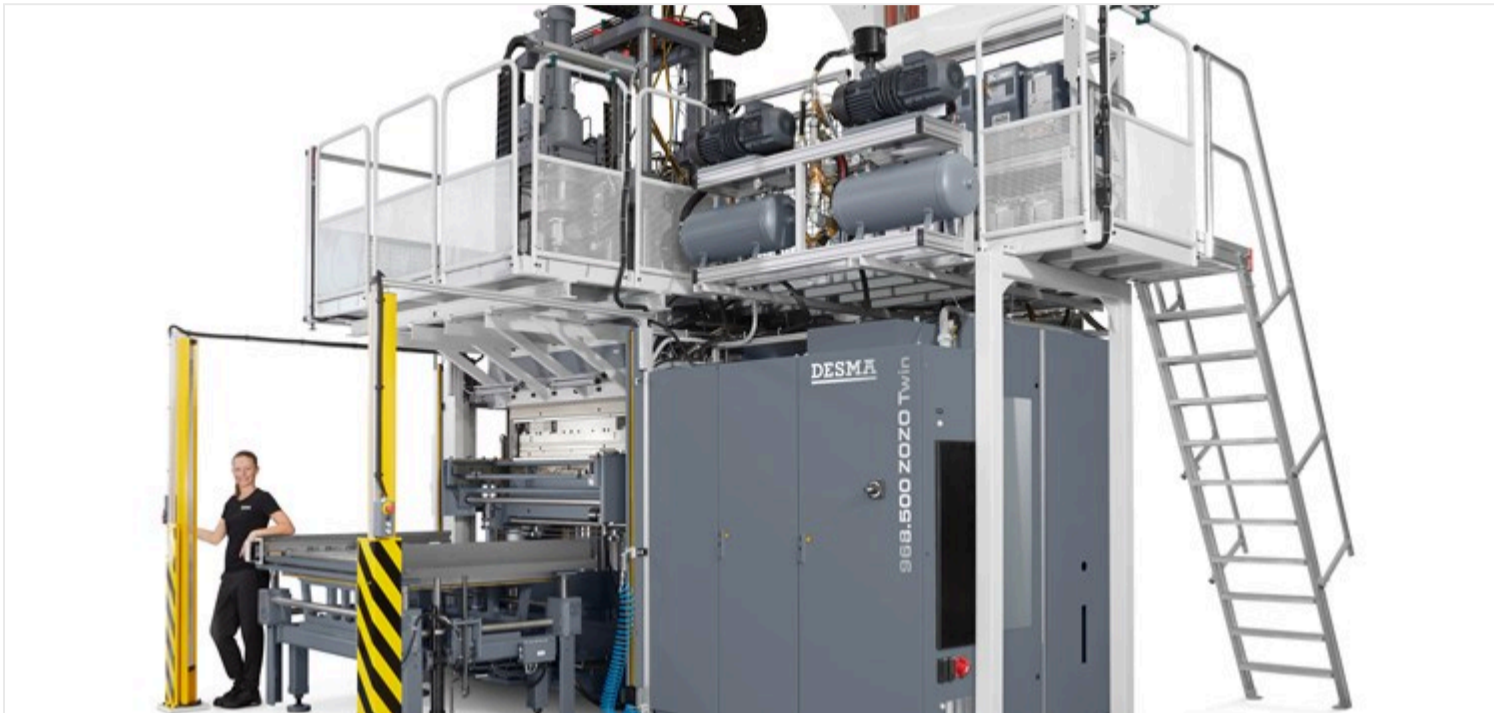
Mit der neuen 968.500 ZOZO TWIN steht eine Maschinenplattform zur Verfügung, die den Schließkraftbereich von 5000kN – 7000kN abdeckt (Bild: Klöckner DESMA Elastomertechnik GmbH)
