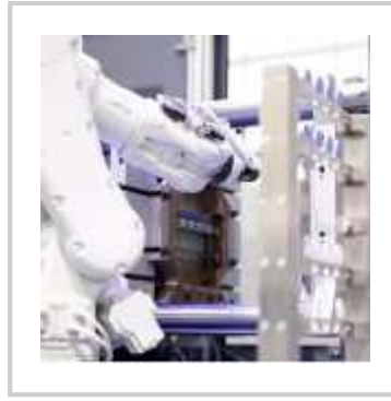
Das kollaborierende 6-Achs-Robotersystem kann einfach an andere Maschinen umgesetzt werden. (Foto: Desma)
