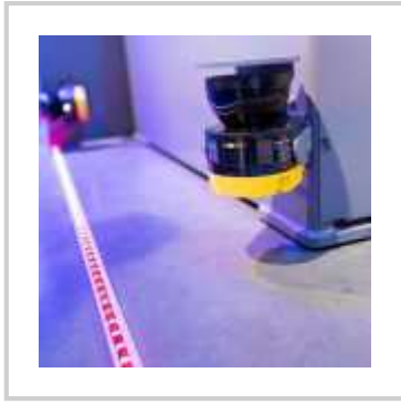
Durch Scannerabsicherung ist ein Arbeiten ohne Schutzgitter möglich. (Foto: Desma)
