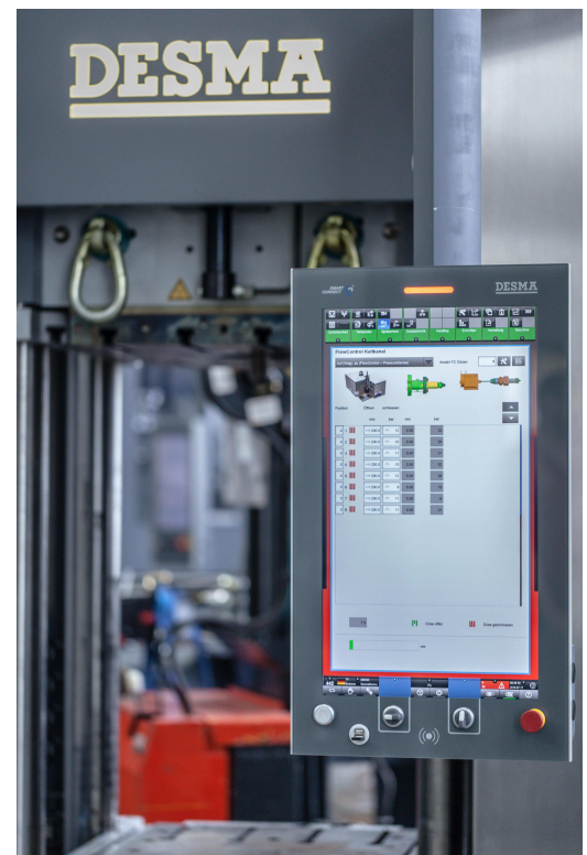
DRC 2030 TBM ist das Desma Rubber Control Tool mit trendbasierter Maschinenvisualisierung. (Quelle: Desma)
